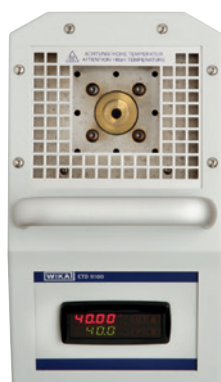
Four d'étalonnage type CTD9100-650
