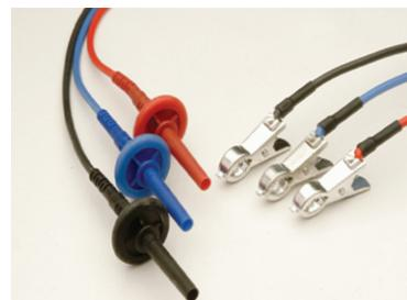
Un **soin extrême** doit être observé afin d'éviter toute décharge électrique lors de la connexion/déconnexion à cause des pinces métalliques nues.
