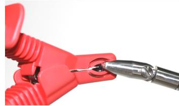
La pince Megger est testée avec des protège-doigts conformes aux normes IEC en matière de lignes de fuite et de distance d'isolement.
