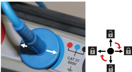
Les flèches sur les protège-doigts de la prise doivent être horizontales sur l'instrument pour verrouiller. Tournez de 90° pour déverrouiller. De plus, pour la même raison, les pinces de test ne peuvent pas être retirées du câble de test.
