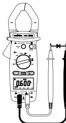
Stellen Sie den Wahlschalter auf . Schließen Sie die rote Messleitung an die Eingangsbuchse "+" und die schwarze Messleitung an die Eingangsbuchse "COM" an. Bringen Sie die rote Prüfspitze mit der Anode der Diode in Kontakt und die schwarze Prüfspitze mit der Kathode. Lesen Sie den Wert der Schwellenspannung auf der Anzeige ab.
