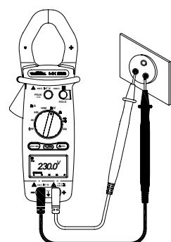
Le symbole  $\sim$  (signal alternatif) doit être affiché. Sinon, appuyer sur la touche  $\sim/\equiv$  pour le faire apparaître.
