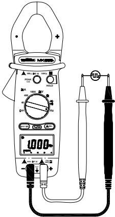
Posizionare il commutatore su "Hz".
