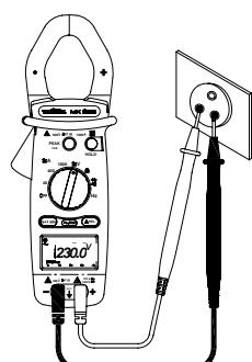
• (MX 655) Stellen Sie den Wahlschalter auf **~V**. Das Symbol **~** (Wechselstrom) muss angezeigt werden. Ist dies nicht der Fall, drücken Sie zur Anzeige des Symbols die Taste **~/---**.
