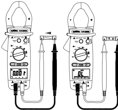
Stellen Sie den Wahlschalter auf . Schließen Sie die rote Messleitung an die Eingangsbuchse "+" und die schwarze Messleitung an die Eingangsbuchse "COM" an. Berühren Sie mit den Prüfspitzen den zu messenden Kreis. Ist der Widerstand geringer als  $R < 75 \Omega \pm 25 \Omega$ , gibt der Summer ein Dauersignal ab.
