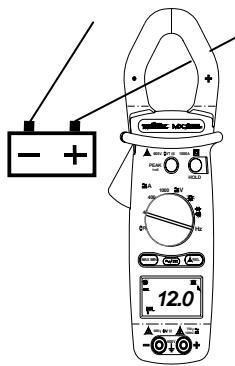
Posicionar el conmutador en 1000 A  $\Delta$ . Pulsar la tecla  $\text{~} / \text{---}$  para visualizar el símbolo  $\text{---}$  (señal continua). Una vez estabilizada la visualización, pulsar la tecla **AREL** para efectuar un ajuste automático del cero DC.
