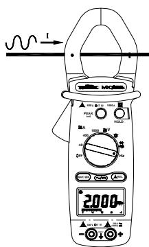
Posizionare il commutatore su "Hz".
