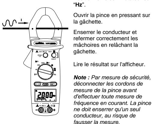
**Note :** Pour faire des mesures de fréquence, on peut donc utiliser, soit les bornes d'entrée (tension), soit les mâchoires de la pince (courant), mais il ne faut jamais utiliser les deux sources à la fois.
