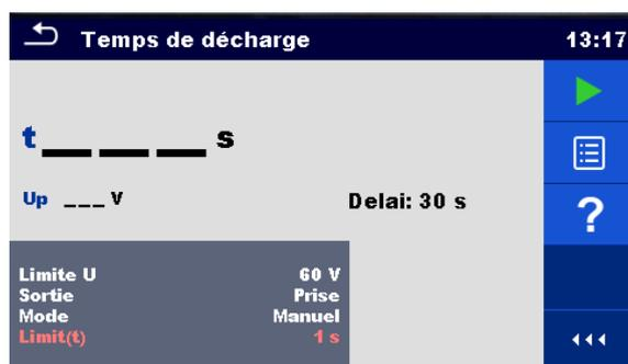
Figure 6.60 : Menu de test du temps de décharge
