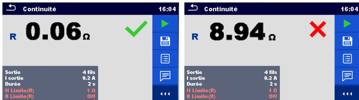
Figure 6.19 : Exemples de résultats de mesure de continuité
