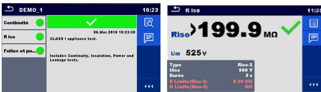
Figure 7.9: Détails dans les écrans du menu des résultats Auto Sequence®
