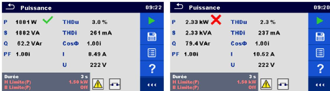
Figure 6.56 : Exemples de résultats de mesure de Puissance
