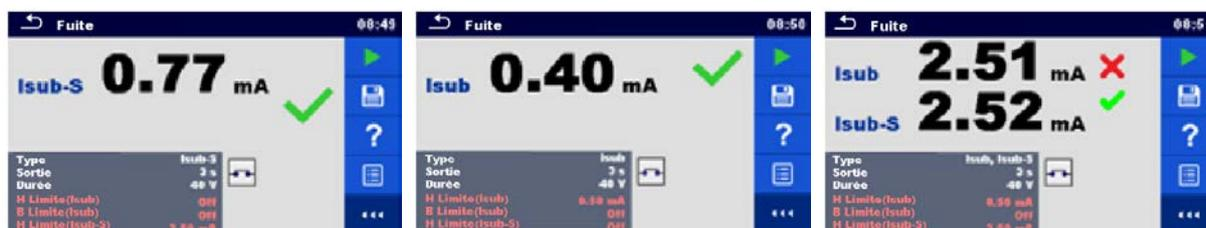
Figure 6.44 : Exemples de résultats de mesure du courant de fuite par la méthode de substitution
