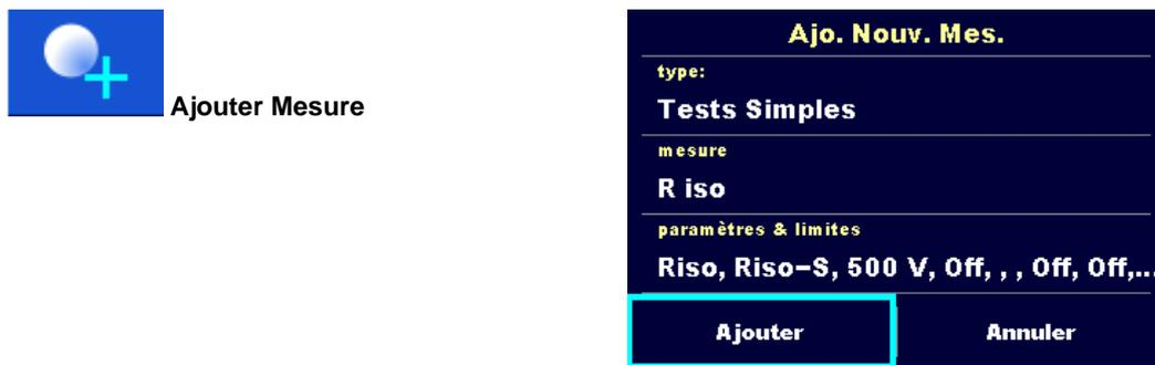
Figure 5.11 : Ajouter un menu Nouvelle mesure
