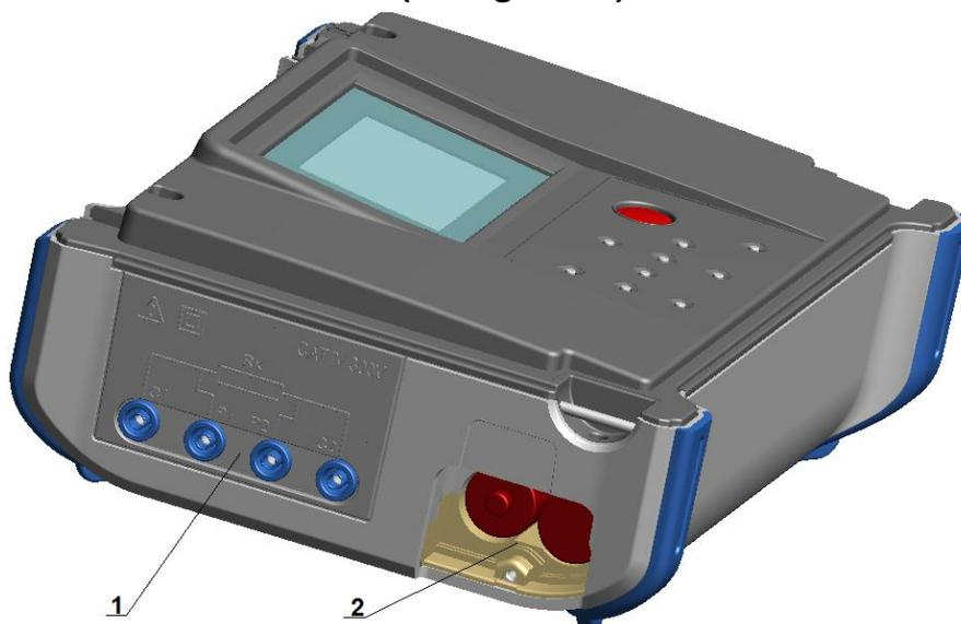
Schéma 3.4: Bornes d'entrées/sorties et compartiment de la batterie
