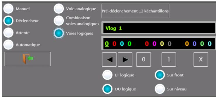
Les 16 voies logiques peuvent être utilisées dans le mot de déclenchement :
