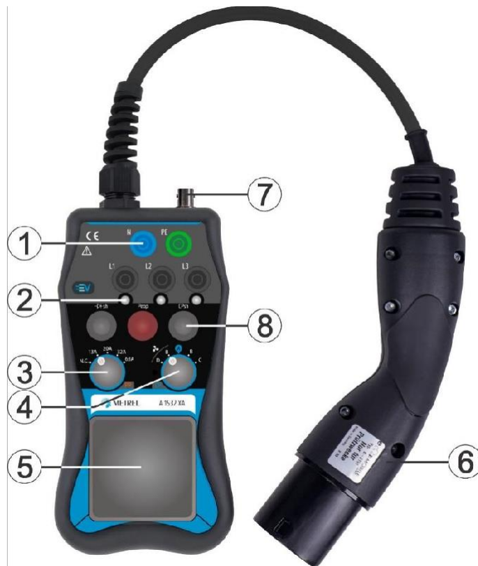
Image 3.1 : Composants de l'accessoire de test des IRVE A1532-XA
