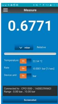
Via l'application "myWIKa device" et la connexion Bluetooth®, le CPG1200 peut être configuré pour les tâches d'étalonnage et d'enregistrement de manière pratique via un téléphone portable. Pendant la mesure de la pression, la valeur est affichée dans l'unité requise directement sur le téléphone mobile. De plus, d'autres paramètres comme le taux de changement de température et de pression peut être surveillé. Il est également possible
