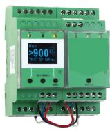
Je veux vérifier le CPI (Contrôleur Permanent d'Isolement) d'un schéma de liaison à la terre IT. Je vais diminuer la résistance d'isolement entre une phase et la terre du schéma de liaison à la terre IT et si le CPI fonctionne correctement alors il devrait m'alerter (certains CPI affichent en plus la résistance d'isolement). Pour ce faire je vais introduire une faible résistance entre la phase et la terre.
