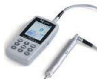
Duromètre à ultrasons
