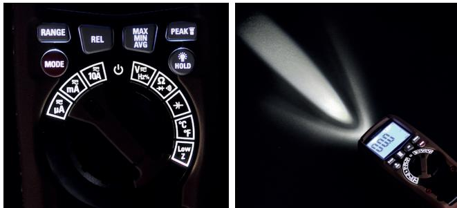
Le TT965(T) dispose d'une caractéristique très particulière qui fait qu'on peut également l'utiliser en pleine obscurité. L'écran, les touches et les différentes fonctions du commutateur s'allument dans le noir.
