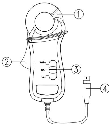
REMARQUE : Pour choisir la sonde de courant de 100 A, appuyez sur le bouton **SETUP** pour sélectionner CLAMP. Lorsque le CLAMP est en vidéo inverse, appuyez sur le bouton **▲** ou **▼** pour sélectionner 100.
