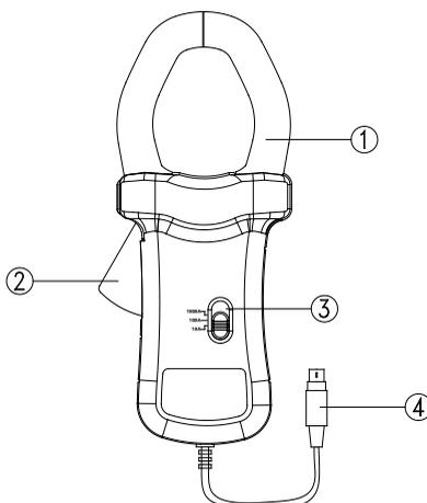
REMARQUE : Pour sélectionner la sonde de courant de 1 000 A, appuyez sur le bouton **SETUP** pour sélectionner CLAMP. Lorsque le CLAMP est en vidéo inverse, appuyez sur le bouton **▲** ou **▼** pour sélectionner 1 000.
