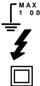
Ce symbole informe l'utilisateur que la ou les borne(s) ainsi marquée(s) ne doivent pas être branchée(s) à un point de circuit où la tension respectant la mise à la terre dépasse (dans ce cas) 1000 V CA ou V CC.
